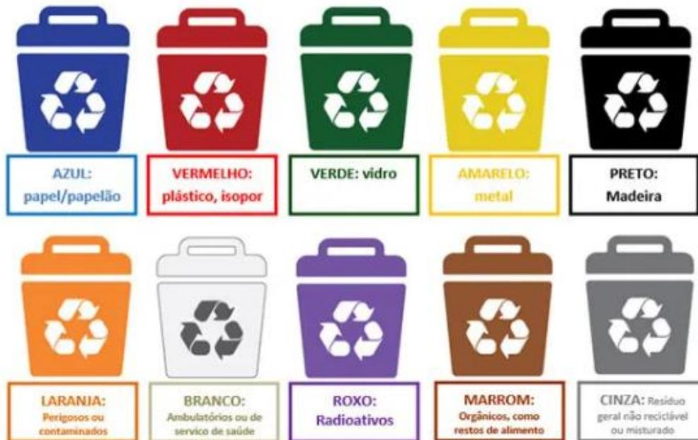
Figura 2 - Definição de cores para cada tipo de resíduo
