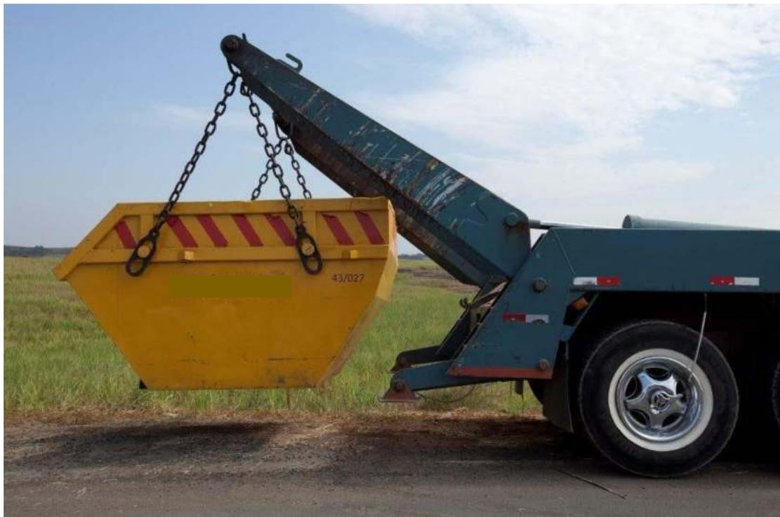
Figura 4 - – Exemplo de acondicionamento de resíduos em caçamba.
